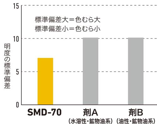
鉍物油系剥離剤2種とSMD-70を用いた建築現場での画像解析ソフトによる明度差(色むら)の評価結果
