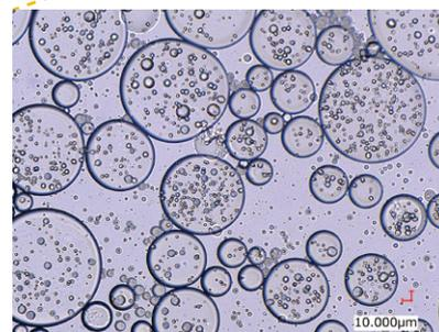
手振乳化での乳化物 顕微鏡観察写真×500倍
