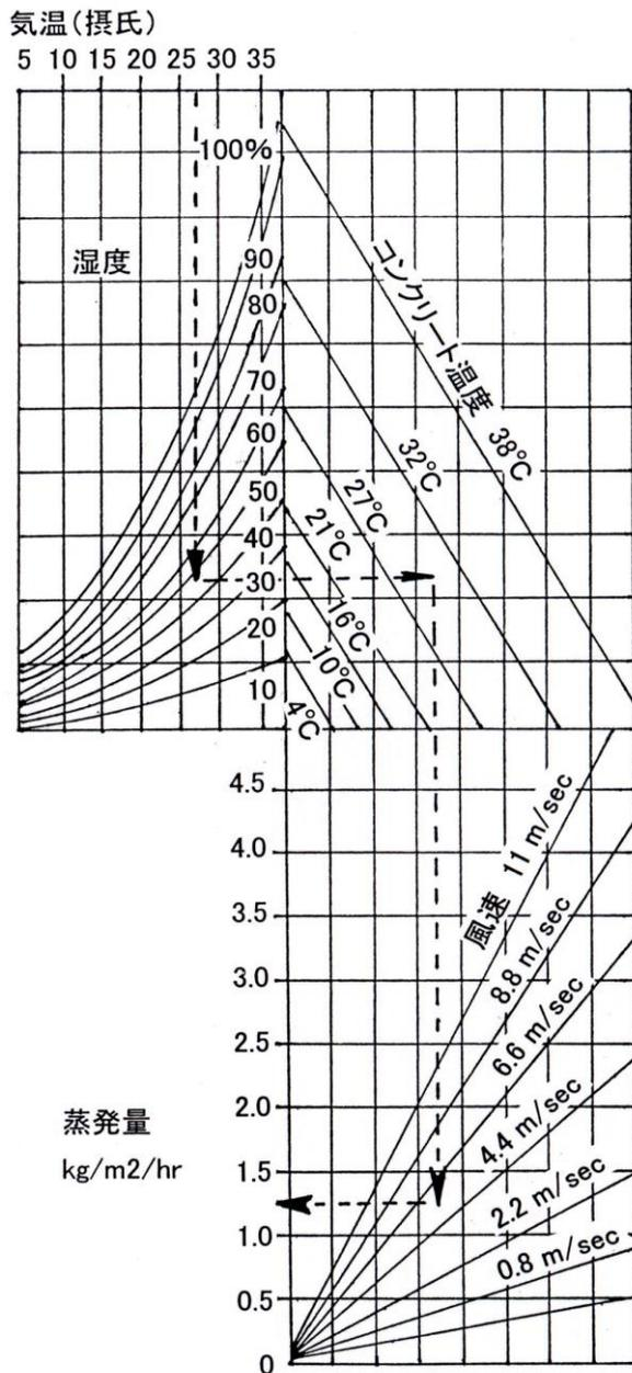
1. ひび割れ発生抑制効果(急激な乾燥による収縮ひび割れの低減)
