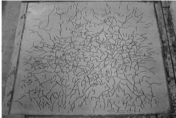
ひび割れ確認試験(アクアフィルム)
