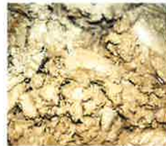
脱水処理ケーキ
