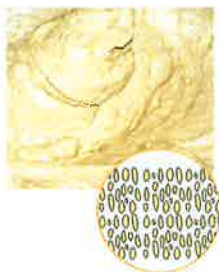
液状限界をやや超える程度に加水攪拌し、流動化
