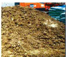
脱水処理ケーキ
