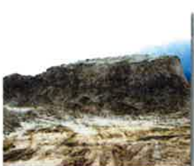
脱水処理ケーキ
